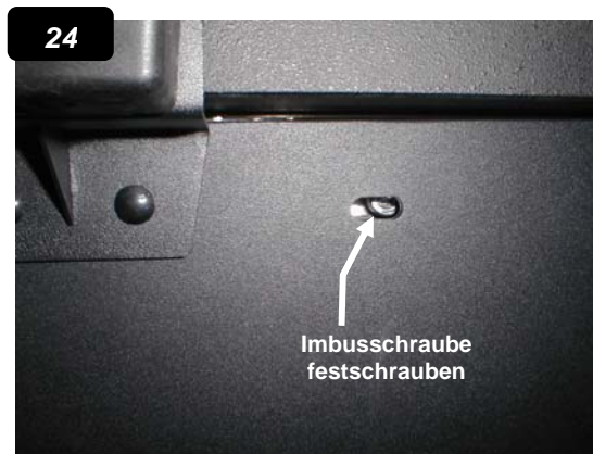
24. Befestigen Sie die Plasmaeinheit links u. rechts jeweils 2x am Grundgestell. Die Schrauben (4x) sind bereits am Plasma angebracht.
