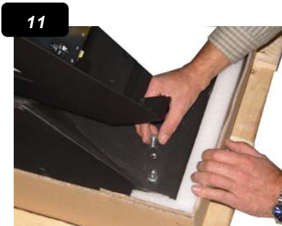
11 Entfernen Sie die 4 Stück Schrauben vom Fußteil
