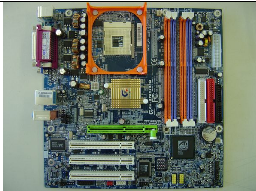
831.000.019 PC Motherboard Gigabyte micro ATX Charge GA8TRS300M (oranger CPU-Sockel): BIOS 49 ab System 309 (SB V10.00) Charge GA-8TRS350 (gelber CPU-Sockel): BIOS 52 ab System 312 (SB V10.02) ACHTUNG: Funktioniert nur mit original Samsung Speicher - 831300015 Charge SAMSORIG
