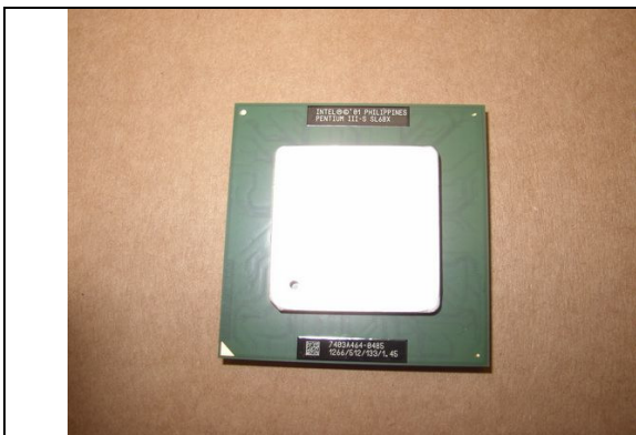
831.000.071 PC CPU Pentium III 1,2 GHz, 512KB Cache für Virtual Pinball und Max Fire (Video) mit QDI Motherboard - 831000044
