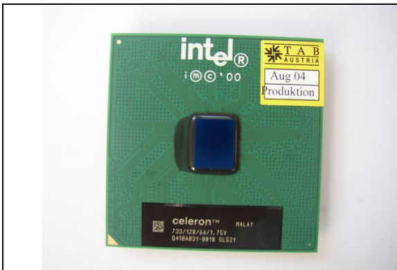
831.000.061 PC CPU Celeron 733MHz, socket 370
