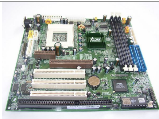
831.000.024 PC Motherboard Acorp 694XT BIOS 46 für 800x600 / BIOS 47 für 640x480 ab System 10 (SB V6.30, MF V1.00) und ab System 122 (MV V1.00)
