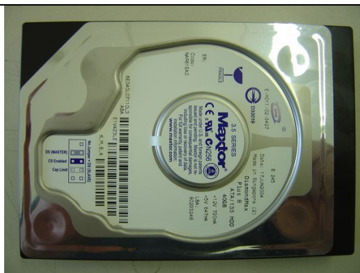
831.000.048 PC Festplatte 40 GB limitierbar auf 32GB Festplatte (40GB, jedoch auf 32GB einstellbar mit "Cap Limit" Jumper) Mit der Einstellung auf 32GB kann sie als Austauschplatte für alle Motherboards verwendet werden, die bis Silverball Version 6.30 ausgeliefert wurden (alle Boards vor Wechsel auf ACORP). Nicht für ACORP und QDI Boards verwenden!
