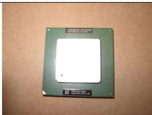
831.000.071 PC CPU Pentium III 1,2 GHz, 512KB Cache für Virtual Pinball und Max Fire (Video) mit QDI Motherboard -831000044
